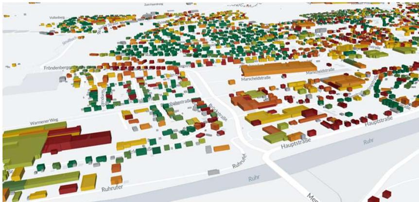
Wärmebedarf - Nutzenergie pro m<sup>2</sup>
